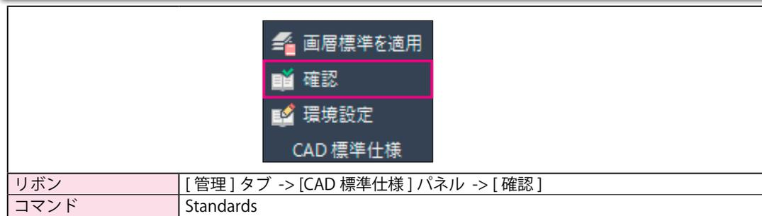
1 作成中の図面を標準図 (dws) と比較して、違反があれば通知する
